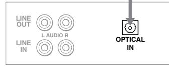
También debería conectar las tomas de salida de audio analógicas del televisor con las tomas de entrada de audio analógicas del amplificador, de manera que el amplificador puede dar salida al audio para los canales analógicos. Para obtener más detalles, consulte la página 45.
