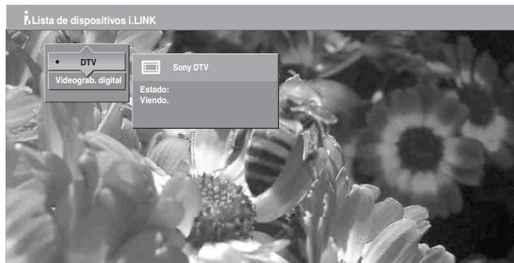
En la lista de dispositivos i.LINK se muestran el televisor (televisión digital), así como todos los dispositivos conectados a éste a través de i.LINK.
